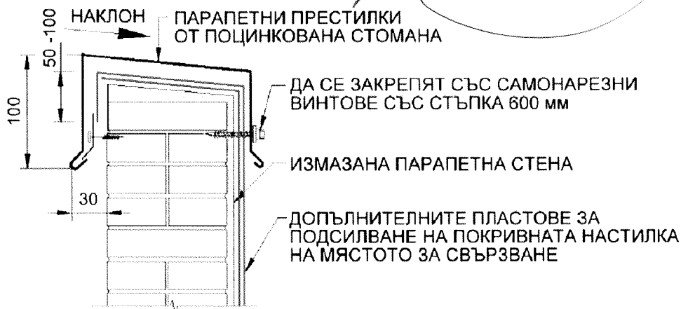
Фиг. 26. Свързване на покривна настилка с парапетна стена с височина по-малка от 500 мм.
