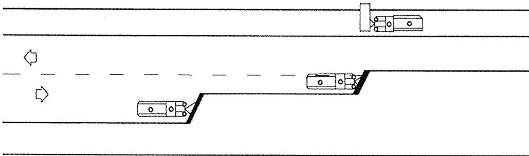
Схема на патрулно снегочистене при двулентови пътища – съгласно *Технически правила и изисквания за поддържане на пътища 2009г., Дял четвърти - Зимно поддържане, Раздел 2 – Почистване на снежни покривки от платното за движение, чл. 292*
