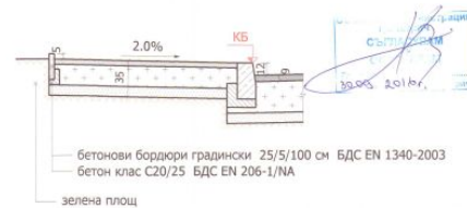
НАПРЕЧЕН РАЗРЕЗ ТРОТОАР/ЗЕЛЕНА ПЛОЩ М 1:25
