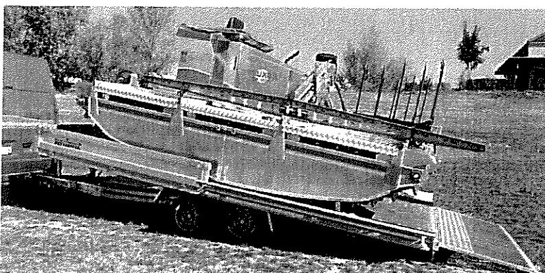
Трейлърът Variant 2700U5 е създаден специално за транспортиране на машини Truxor. Variant 2700U5 е оборудван с колани за пристягане, падащи странични панели от алуминий, сгъваема задна рампа, хидравличен преден повдигач, падаща задна рампа с газови амортизори, които улесняват повдигането и свалянето на рампата. Водещи релси подпомагат товаренето и разтоварването на амфибията.
